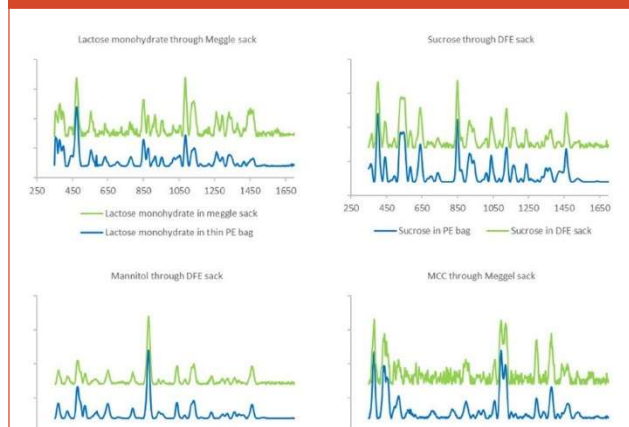
FIGURA 2: Sacarosa y manitol a través de un saco DFE, MCC y monohidrato de lactosa a través de un saco Meggle. Espectros Raman SORS superpuestos con espectros de sacarosa, manitol, MCC, y monohidrato de lactosa a través de un revestimiento de polietileno.
