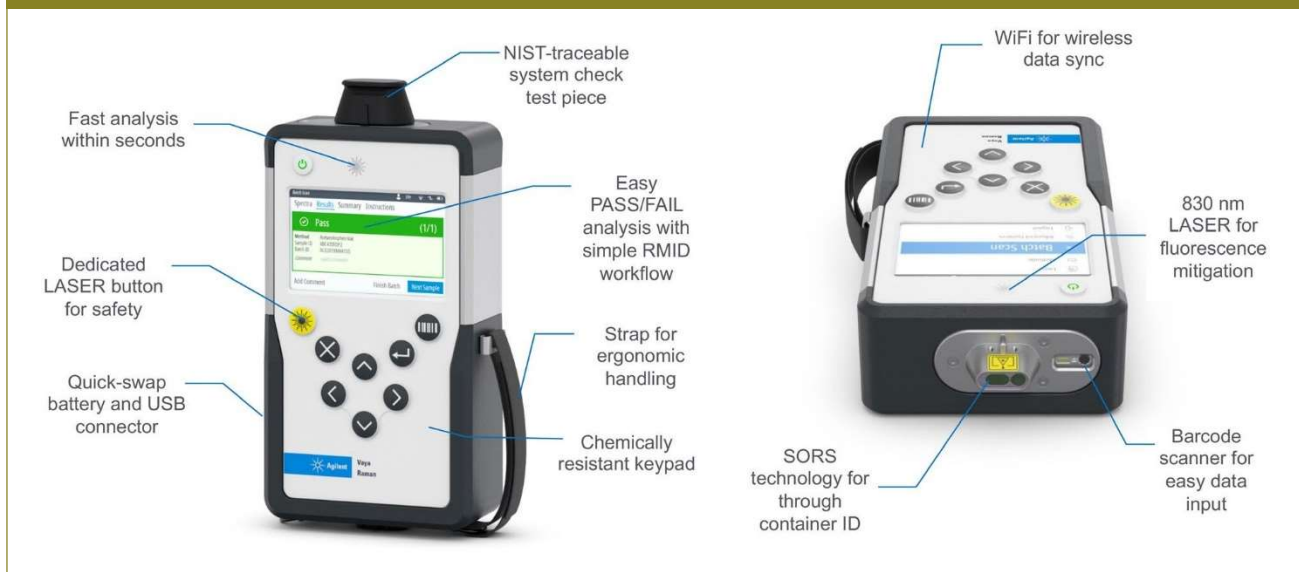
FIGURA 5: Características claves del hardware del sistema VAYA de Agilent
