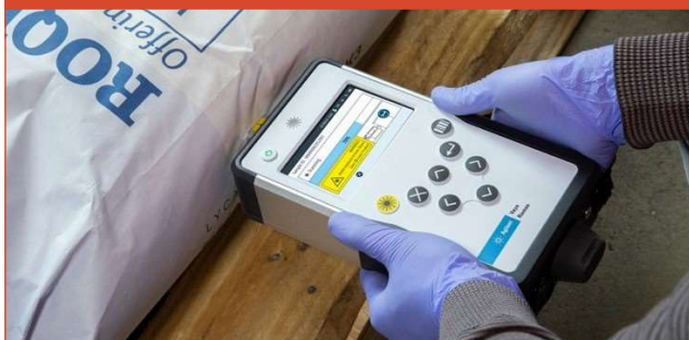
FIGURA 1: Uso del sistema VAYA para identificar contenidos a través de sacos de papel multicapa.
