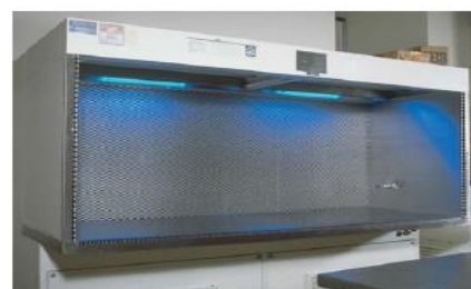
Cabina de flujo laminar con luz UV en su interior.
